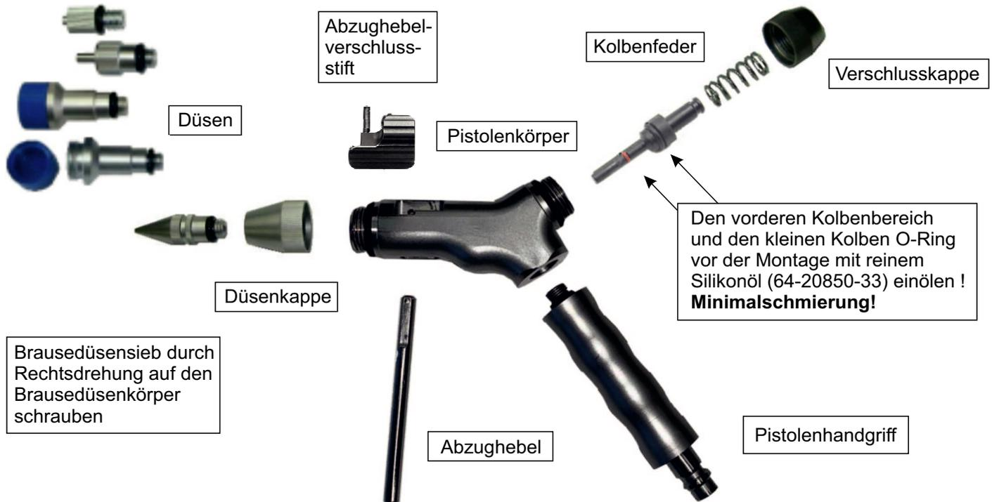
Überprüfen Sie bitte vor der Montage, ob alle abgebildeten Dichtungsringe vorhanden und intakt sind!
