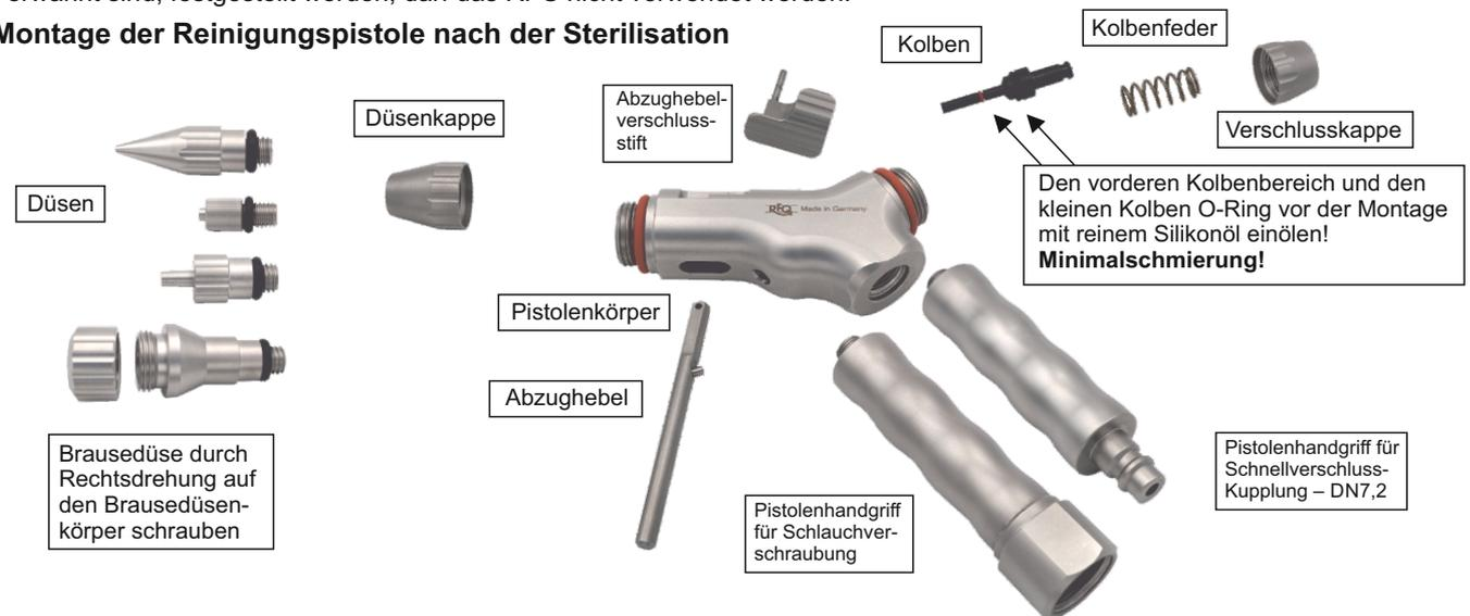
Überprüfen Sie bitte vor der Montage, ob alle abgebildeten Dichtungsringe vorhanden und intakt sind! Alle Teile **durch Rechtsdrehung handfest** verschrauben. Keinesfalls die Teile ohne Dichtringe verschrauben. (Kaltverschweissung)
